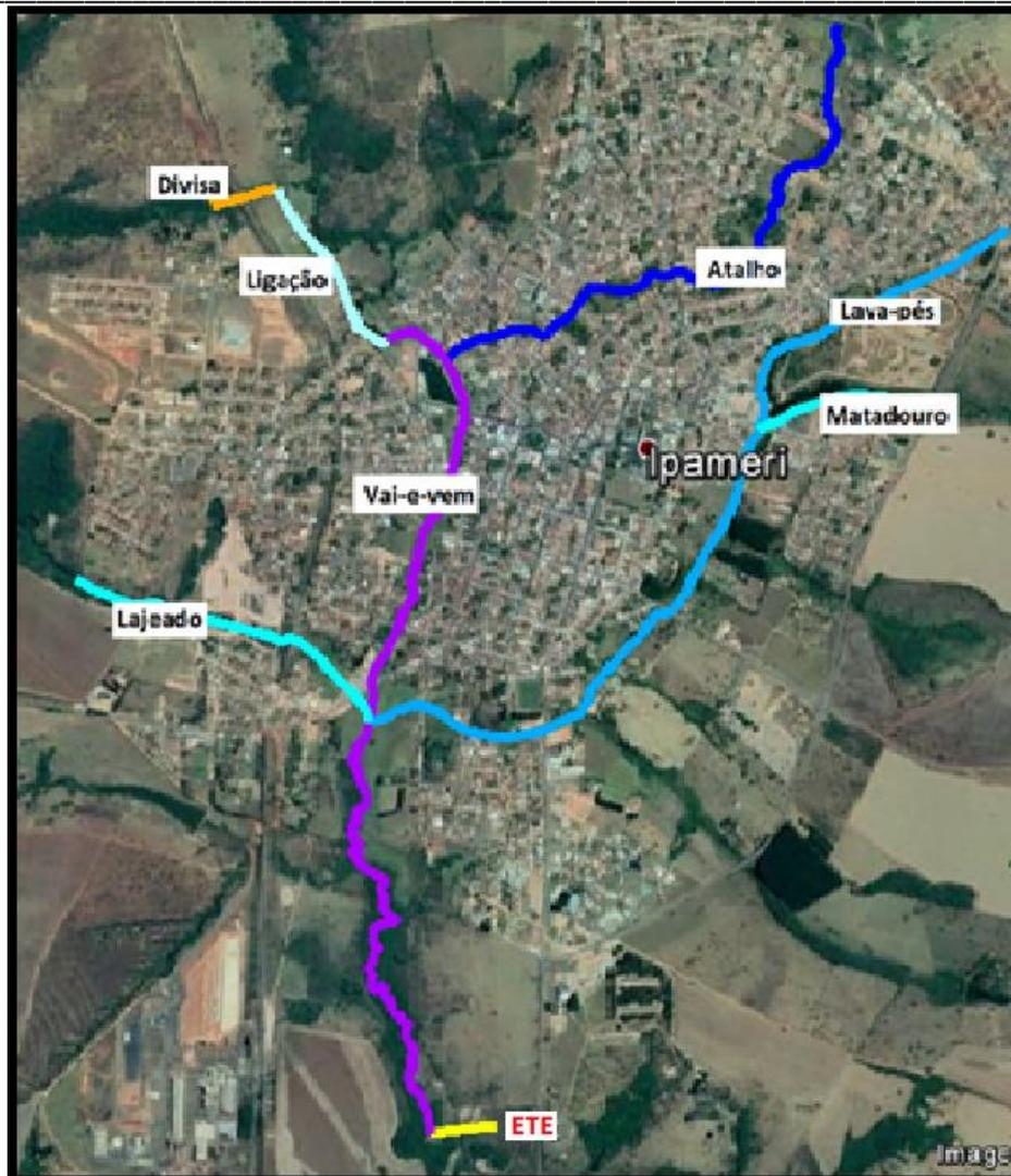
Entre o final do interceptor e a ETE temos uma distância de aproximadamente 250 m e um desnível de 15 m a ser vencido. Deveremos ter uma elevatória com potência de 25 cv e um emissário com DN 300 mm
